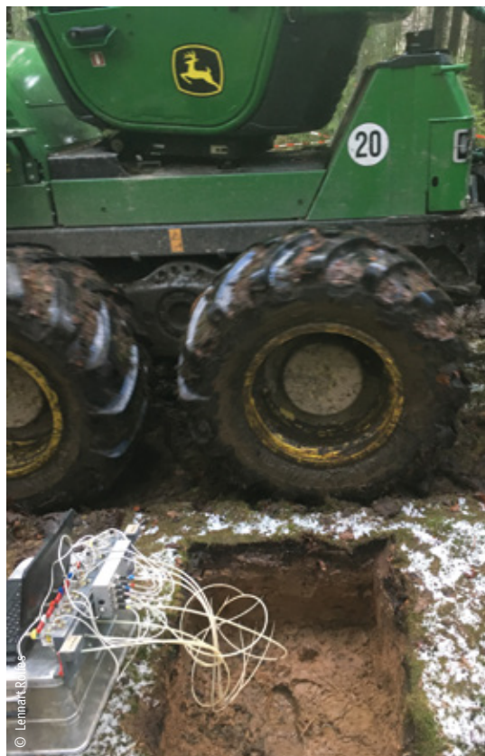
Setzungsmessung im forstlichen Einsatz
