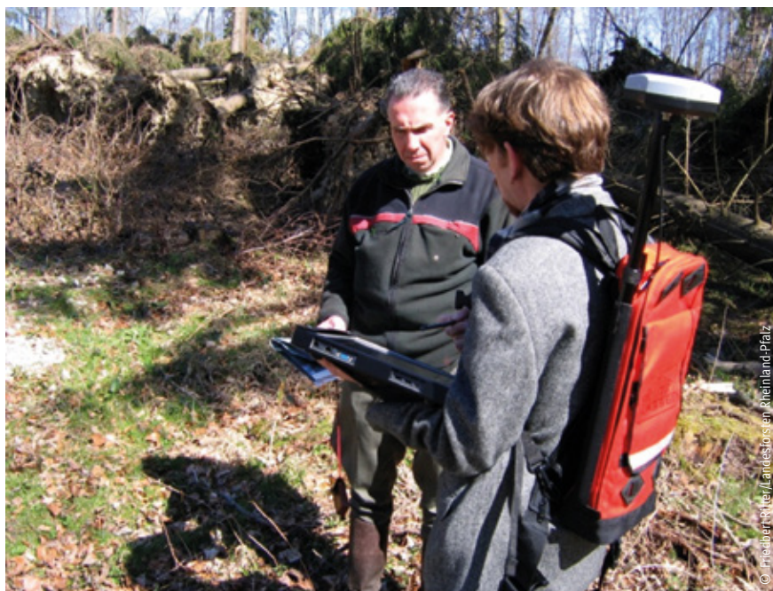
Abb. 8.1: Felderfassung zur Rekonstruktion von Rückegassen in Sturmwurfflächen auf der Basis von D-GNSS (Differentielles Globales Satellitensystem).
