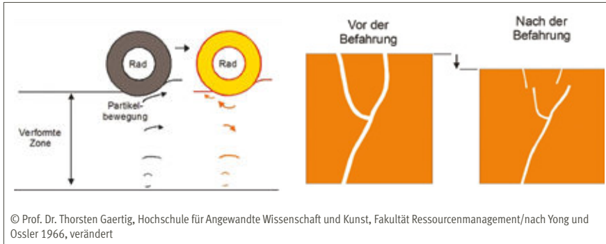
Abb. 4.1: Bei der Befahrung wirken vertikale und horizontale Kräfte auf den Boden. Die Bodenverformung führt zu einem Verlust an Porenraum und zusätzlich zu einer reduzierten Vernetzung der verbleibenden Poren.
