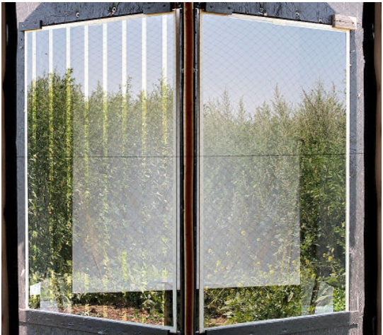
Eine in Entwicklung stehende Markierung (Fraunhofer ISE) mit transparenten Streifen auf Position 1 erwies sich als hoch wirksam (links Prüf-, rechts Referenzscheibe).
