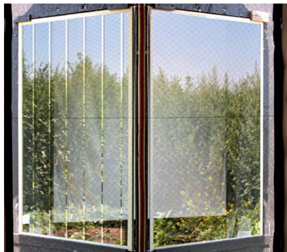
Arnold Glas Orniflex® design lines 5/95: hoch wirksame Metallmarkierung mit klassischem Streifenmuster (links Prüf-, rechts Referenzscheibe).
