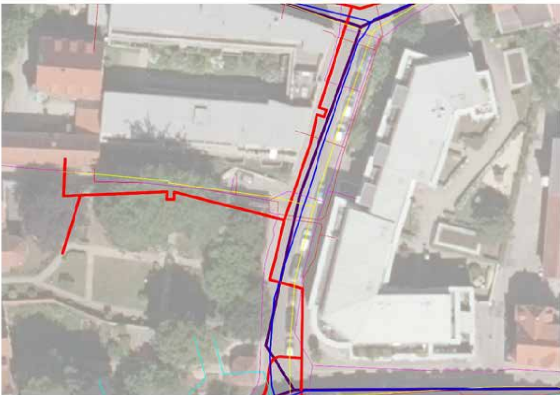
Abbildung 42: Planausschnitt: Spartenkoordination „Bei St. Barbara“ (o. M.) Quelle: MNE LA
