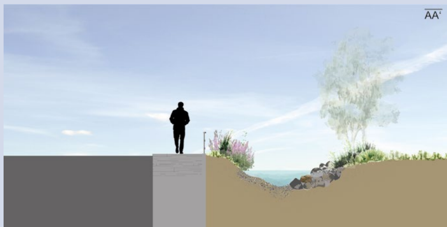
Gestaltungsmöglichkeit für einen Bach mit schmalen Gewässerkorridor (Querschnitt)
